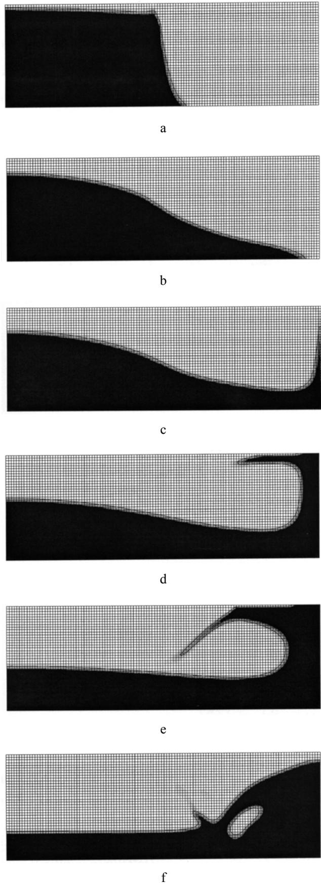
Fig. 3 Time evolution of the dam break flow, the pseudo-concentration function and stationary finite element mesh: a -  $t=0.025\text{s}$ ; b -  $t=0.075\text{s}$ ; c -  $t=0.100\text{s}$ ; d -  $t=0.15\text{s}$ ; e -  $t=0.200\text{s}$ ; f -  $t=0.275\text{s}$
